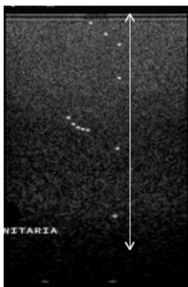
È un parametro in prima approssimazione inversamente proporzionale alla frequenza utilizzata e può essere influenzato dalle caratteristiche dell'impulso e della focalizzazione. Un peggioramento delle caratteristiche di penetrazione si correla in genere con problemi di potenza di emissione, disturbi nella ricezione e perdita di integrità del trasduttore.
