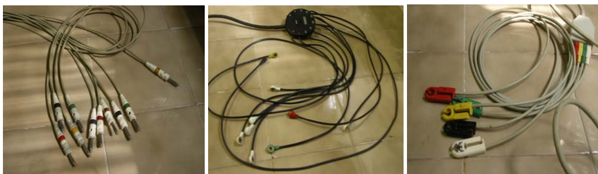
Figura 44 – In sequenza a partire da sinistra: elettrodi a spinotto, a bottone e a pinza
