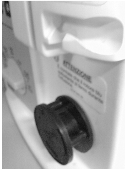
Fig. 24 Particolare di pompa enterale: è possibile notare il meccanismo di infusione composto dalla pompa peristaltica rotatoria
