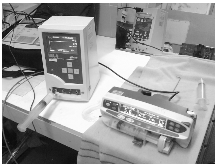
Fig. 37 Un momento del test di flusso ad una pompa a siringa Cardinal Health. L'analizzatore IDA4 mostra il profilo dell'infusione in tempo reale
